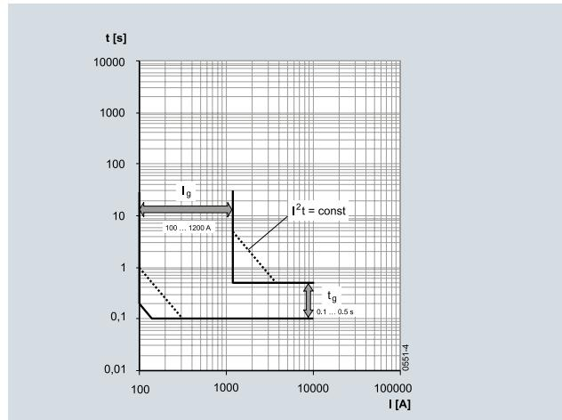
配备 ETU47WT 电子脱扣器的 3WT8 断路器，G 特性曲线<sup>1)</sup>
