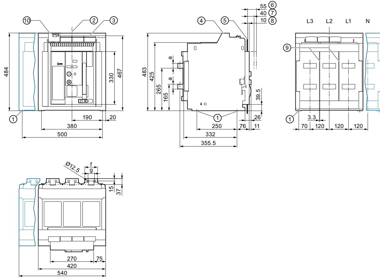
① 导向框架安装孔  $4 \times \varnothing 9$
