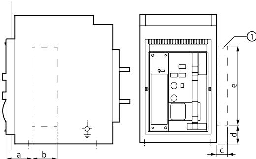
① 互锁模块的间隙 (无鲍登线)
