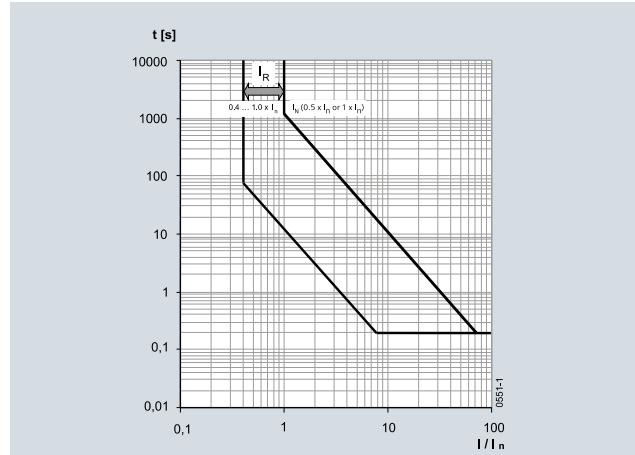
配备 ETU45WT 和 ETU47WT 电子脱扣器的 3WT8 断路器，L 特性曲线
