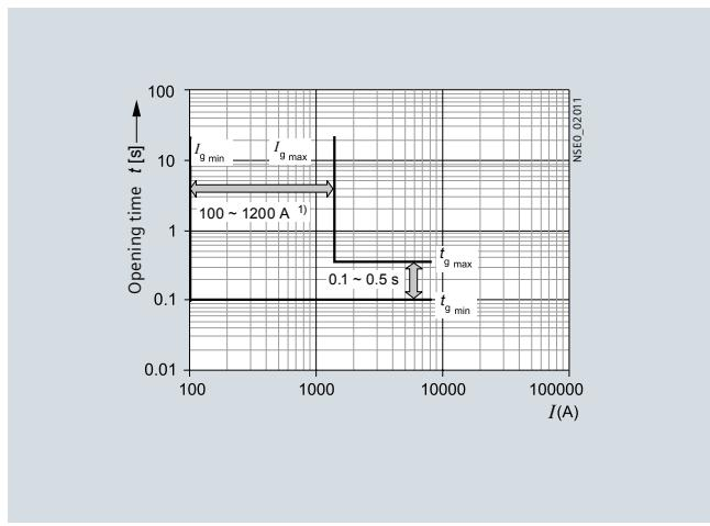
配备 ETU37WT 电子脱扣器的 3WT8 断路器，G 特性曲线<sup>2)</sup>
