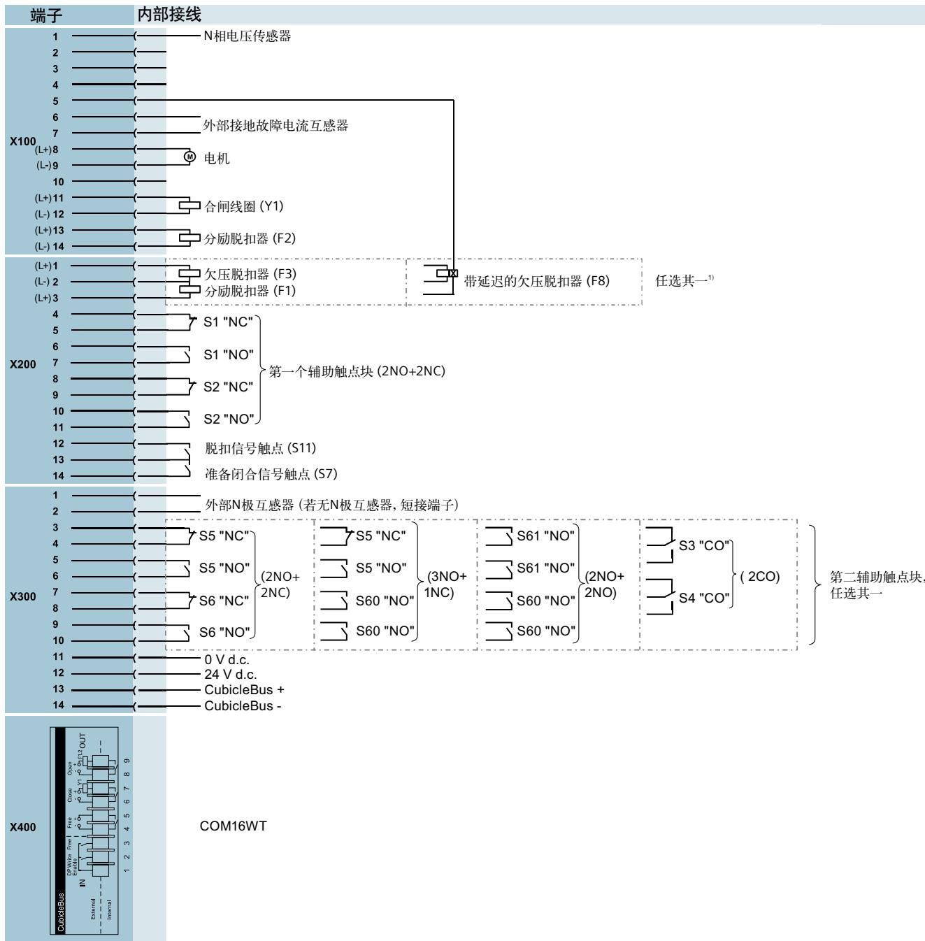
1) 如果选择欠脱扣器 F3，则分励脱扣器将变为 F2，接线端子为 X100.13、X100.14。
