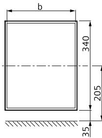
将断路器安装在开关柜中且门处于中间位置时的切口。
